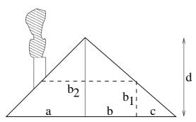
Die gegebenen Längen sind:  $a=16\text{m},\ b=5\text{m},\ c=3\text{m}$  und d=7.2m. Berechne die Längen der (gestrichelt gezeichneten) Balken  $b_1$  und  $b_2$ .
